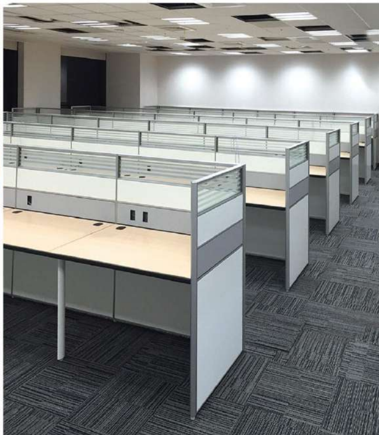
▲走線槽，線路完全隱藏不外露。
